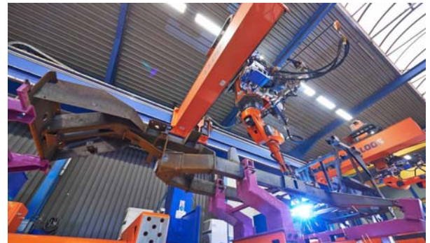
Auf der Anlage werden komplexe Rahmen und tragende Chassis für die Landmaschinenindustrie verschweißt
