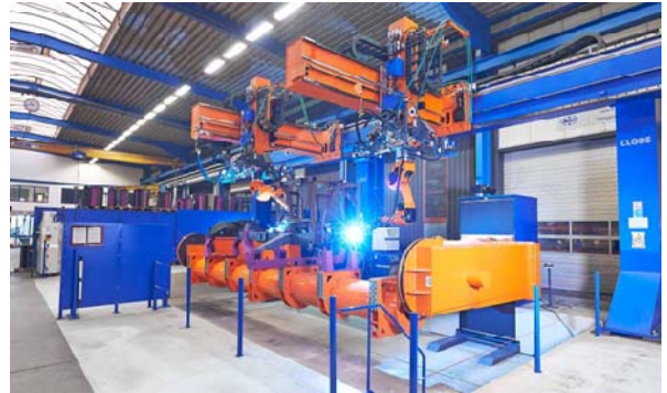
Zwei eigenständige Schweißroboter können im Ein- und Zwei-Stationen-Betrieb unterschiedlichste Bauteile bearbeiten
