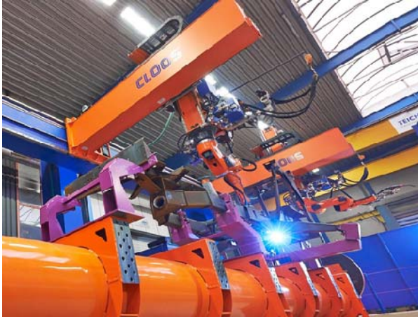
Die beiden Werkstückpositionierer können jeweils Bauteile von etwa fünf Tonnen Gewicht aufnehmen
