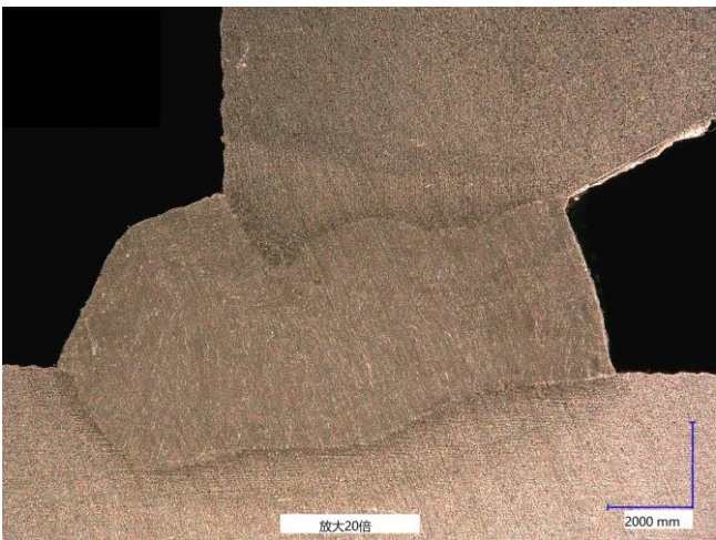
图 2：焊缝截面：单面焊接（右面），T 形接口，坡口 30°
