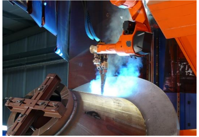
图 3：紧凑型双丝焊接机器人，用于焊接船舶推进器的锥形支撑管
