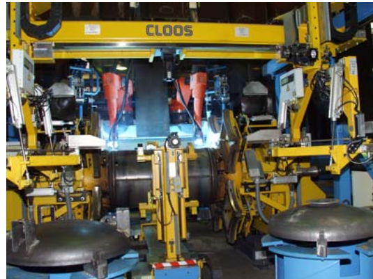
Die beiden QIROX®-Roboter verschweißen parallel Deckel und Boden mit dem Mantel des BOSCH-Wasserspeichers.
