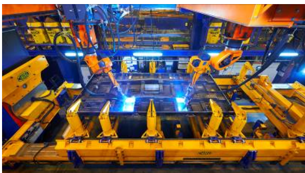
Die beiden sechsachsigen Roboter sind mit je zwei Schweißbrennern und drei Sensoren ausgestattet.
